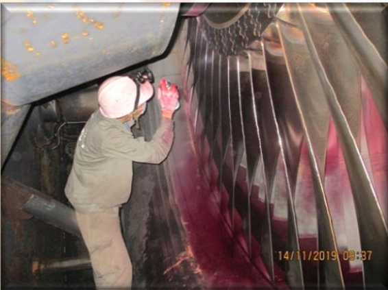
Kiểm tra bằng phương pháp thẩm thấu (PT)
